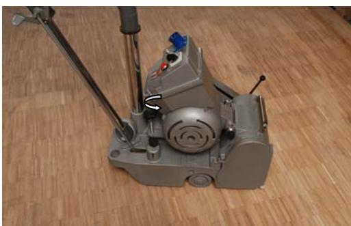
Desserrer la poignée arrière moteur
